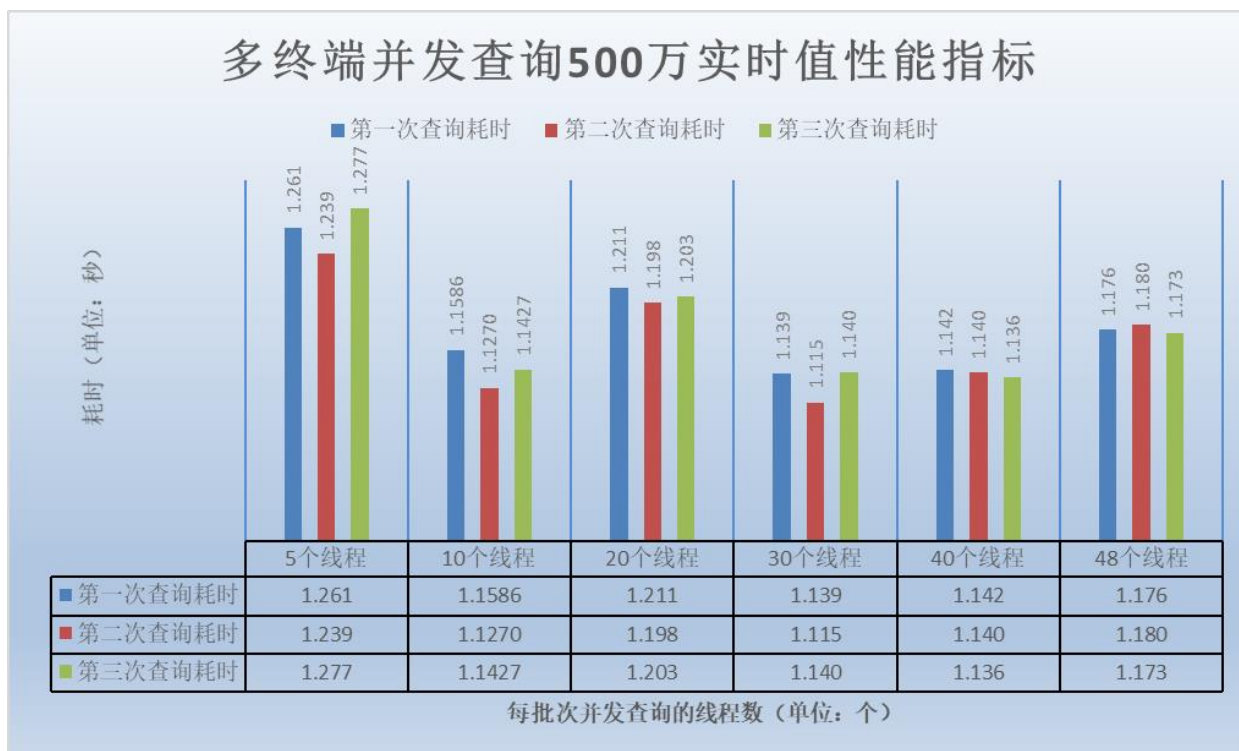
图 5-5 多终端并发查询 500 万实时值性能指标
